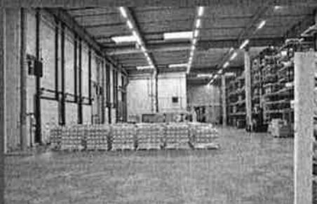
**1.** La première cellule de réception et de stockage (allées étroites). Un premier contrôle qualité est réalisé dès le déchargement. Les chariots reconnaissent les emplacements de stockage grâce à un code datamatrix spécifique et y acheminent la marchandise automatiquement.
